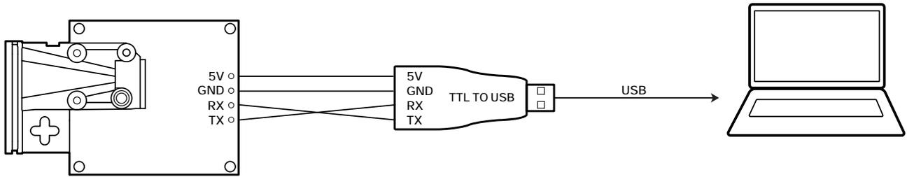
图 2. L1 接线图（EN 脚功能详见 2.1 电气接线图处的说明）
