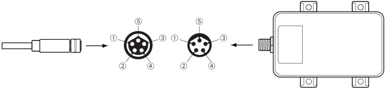
图 5. 航空线及产品接头示意图
