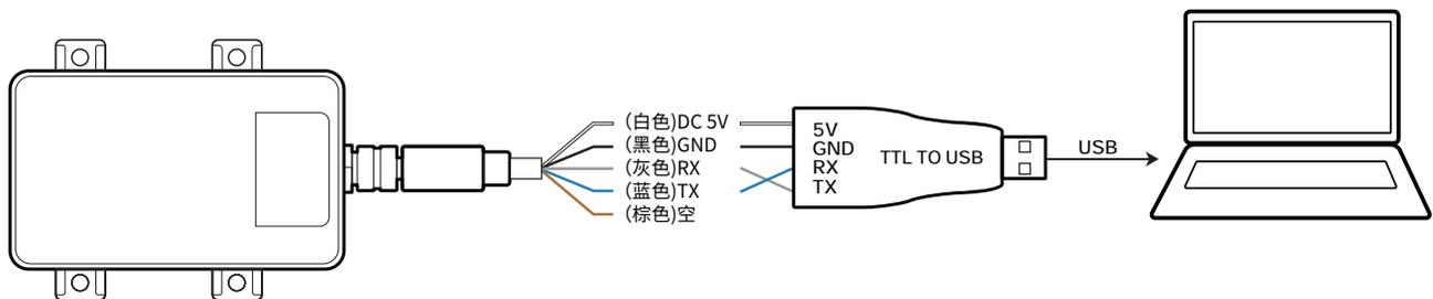
图 3. L1S/L1S-Filled 接线图（棕色线不接）
