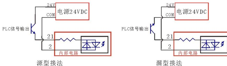
图 2-11: 测量使能信号与 PLC 接线图
