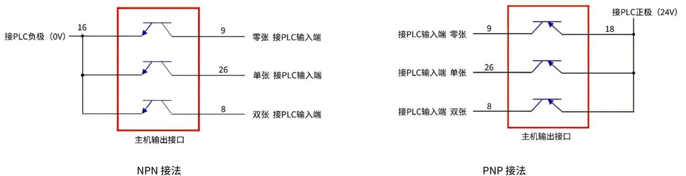
图 2-7: 主机输出接口与 PLC 接线图
