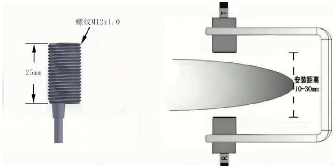
图 3-1：传感器安装示意图
