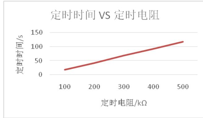
图4 ONTMIE 脚接 1nF 电容到地
