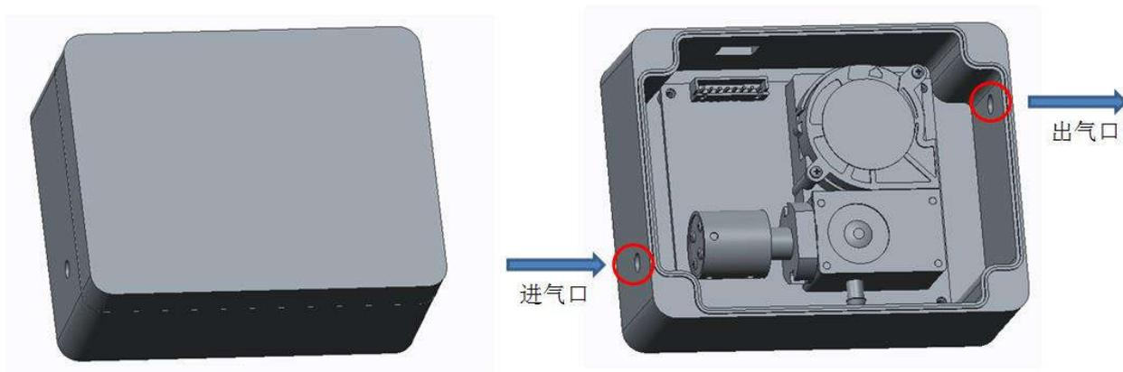
图8 泵吸型安装方式图
