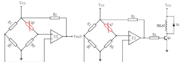
这是一个通过设定特定压力来控制开和关的典型应用电路，它由一个惠斯通电桥和一个电压比较器构成。当压力增大使得传感器电阻小于  $R_1$  时，电压比较器  $U1+$  高于  $U1-$ ，输出高电平。输出的高电平可以为后面附加的器件提
