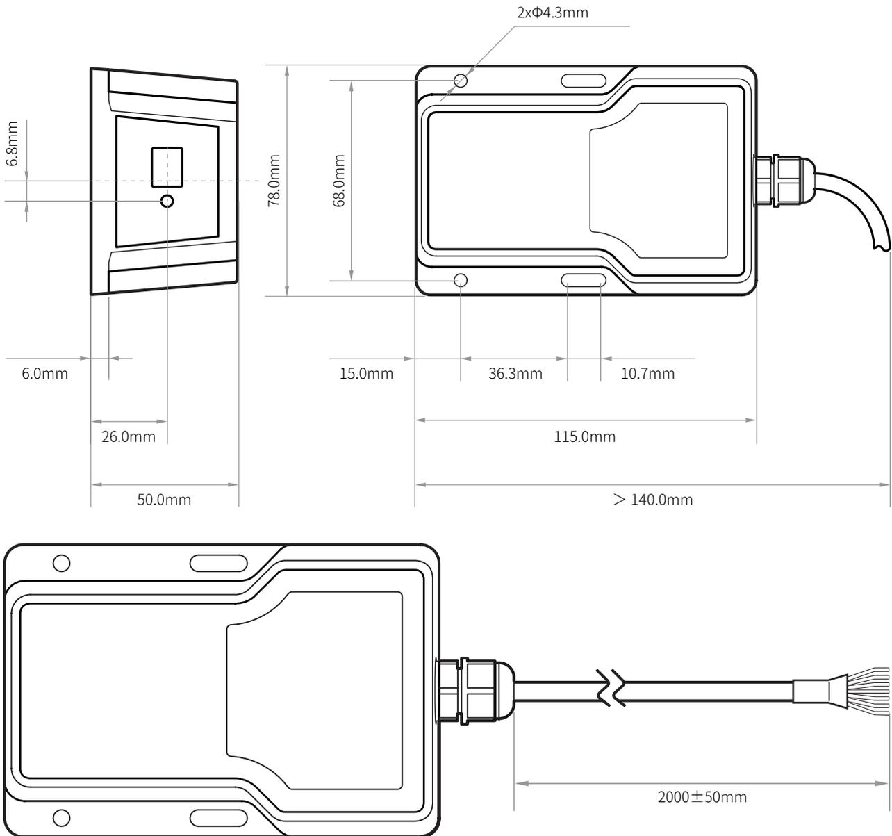
图 4. L3s/L3s-Filled 尺寸图
