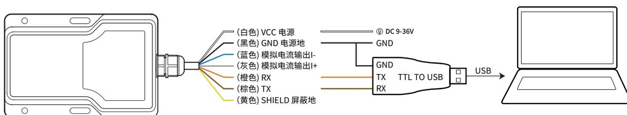
图 2. L3s/L3s-Filled 接线图
