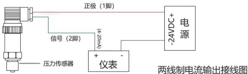
红线: 24VDC 绿线: 电流输出
