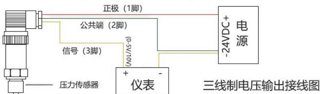
红线: 24VDC 绿线: 电源- 黄线: 电压输出+
