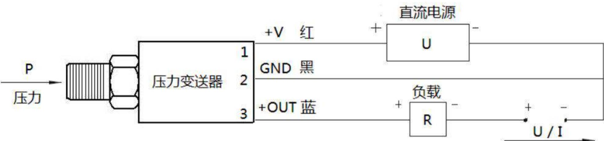
(三线制电压输出型变送器的电气接线图)
