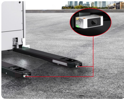
AGV前行避障检测
