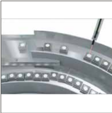
检测LED灯珠的正反面
