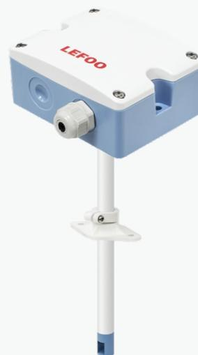
LFS10风速变送器的基于热传导原理, 风速变送器传感器探头采用MEMS技术制造, 具有测量精度高、测量范围大、稳定性好、环境适应性强等特点, 是暖通空调(HVAC), 管道风量测量、过程和环境控制等应用场景风速测量的理想选择。
