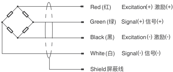
Wiring code 接线图
