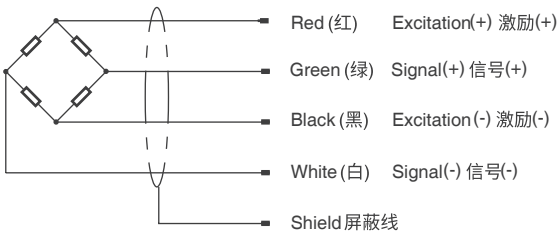
Wiring code 接线图
