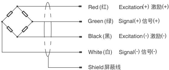
Wiring code 接线图
