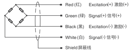
接线图 Wiring code
