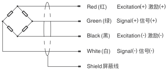
Wiring code 接线图
