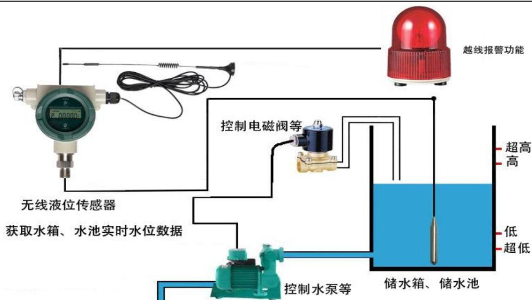
◎使用固定装置将液位表固定好，将液位计探头放在水箱或水池底部。
