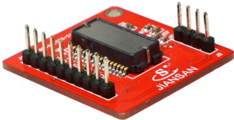
SCHA634 传感器模块是基于村田 SCHA634-d03 6 轴陀螺惯性测量单元，内置高精度 3 轴 MEMS 陀螺仪和 3 轴 MEMS 加速度计，可输出加速度信息和角速度信息，同时能够结合用户算法输出欧拉角实现被测物体的姿态（含方位角、俯仰角、横滚角），适用于运动、震动或静止各种状态下的惯性测量。
