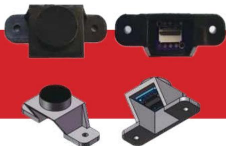
基于威勤传感SensorEdge智能传感器平台系列化超声ToF传感器
