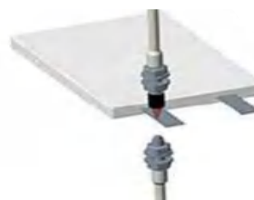
检测电池的两个极耳端位置
