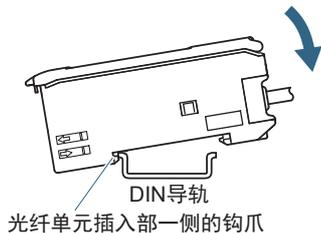
**注.** 请务必将光纤单元插入部一侧嵌入导轨进行安装。逆向安装会导致安装强度下降。
