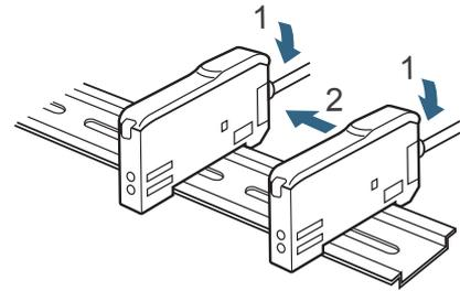
**注.** 因为会有振动等可能导致连接部脱离时，请使用另售安装配件(PFP-M)进行固定。请采用相反顺序进行拆卸。请务必在拆卸放大器单元后再从DIN导轨上拆下。
