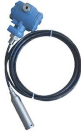
PTL601S数显液位变送器采用扩散硅压阻芯体316全不锈钢结构，带三位半数字显示，可直接显示现场压力，主要适用于河流、地下水位、水库、水塔及容器等的液位测量与控制。
