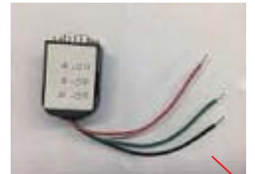
出线转接头 配置为RS485时 红: A (+) 绿: B (-) 黑: COM 黄: 公共端
