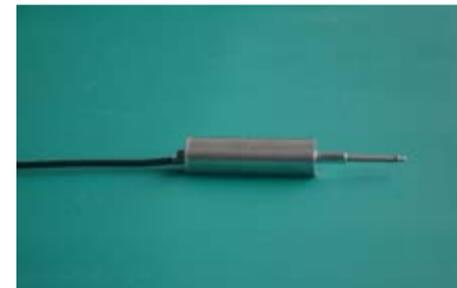
电阻式位移计输出模拟电压信号,适应静态和动态的测量,适用电阻应变仪,以及以电阻桥信号输入的控制。应用于模型试验、桥梁和轨道的振动及位移、以及混凝土和钢材等结构裂缝的监测。
