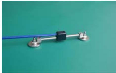
表面型应变计广泛应用于桥梁、建筑、铁路、交通、水利水电、大坝、地下建筑、试桩、试验室模型等领域各种钢结构或混凝土结构表面的应力应变测量,充分了解被测构件的受力状态,结合我司多通道振弦采集系统,可实现长期监测和自动化测量。
