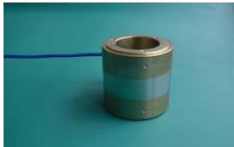
锚索测力计适用于锚索、岩石锚杆、锚栓、拱形支架的荷载及其它重型荷载的监测。锚索测力计本身为高强度的合金钢圆筒,不同荷载的锚索测力计分别内置3或6支高精度振弦式传感器,传感器可监测作用在锚索测力计上的总荷载。同时通过测量每支传感器的变化,还可获取不均匀荷载或偏心荷载。
