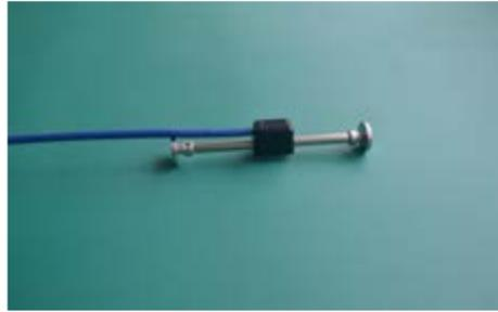
埋入型应变计广泛应用于桥梁、建筑、铁路、交通、水利水电、大坝、地下建筑、试桩、试验室模型等领域混凝土内部的应力应变测量,充分了解被测结构的受力状态,结合我司多通道振弦采集系统,可实现长期监测和自动化测量。
