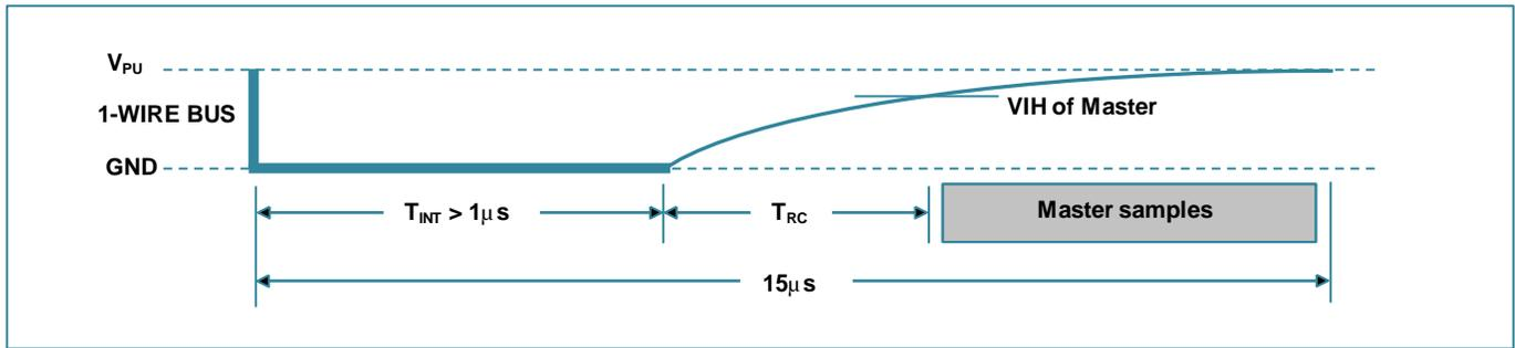
图 16. 推荐的控制度 1 时序
